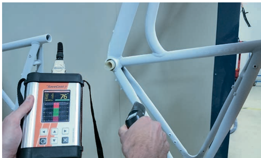
Bild 1 > Auch auf gekrümmten Flächen, wie zum Beispiel an diesem Fahrradrahmen, lässt sich mit den Handultraschallgeräten zuverlässig messen.
